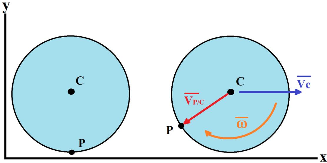
Figura 4. Velocidad de un cuerpo rígido que experimenta movimiento plano general: El vector  $\bar{V}_C$  es la velocidad lineal que experimenta el centro de rotación del cuerpo C, P es cualquier punto de análisis en el cuerpo rígido, el vector  $\bar{V}_{P/C}$  es el vector que va desde el centro de rotación al punto de análisis P y  $\omega$  es la velocidad angular del cuerpo con respecto de C
