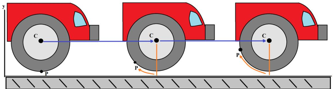
*Figura 3. Movimiento plano general de una llanta. En la figura se aprecia que el movimiento del centro C de la llanta es de tipo traslacional y el movimiento del punto P ubicado en la periferia es rotacional con respecto del punto C, pero no es ni traslacional ni rotacional con respecto a los ejes coordenados “x” y “y”.*
