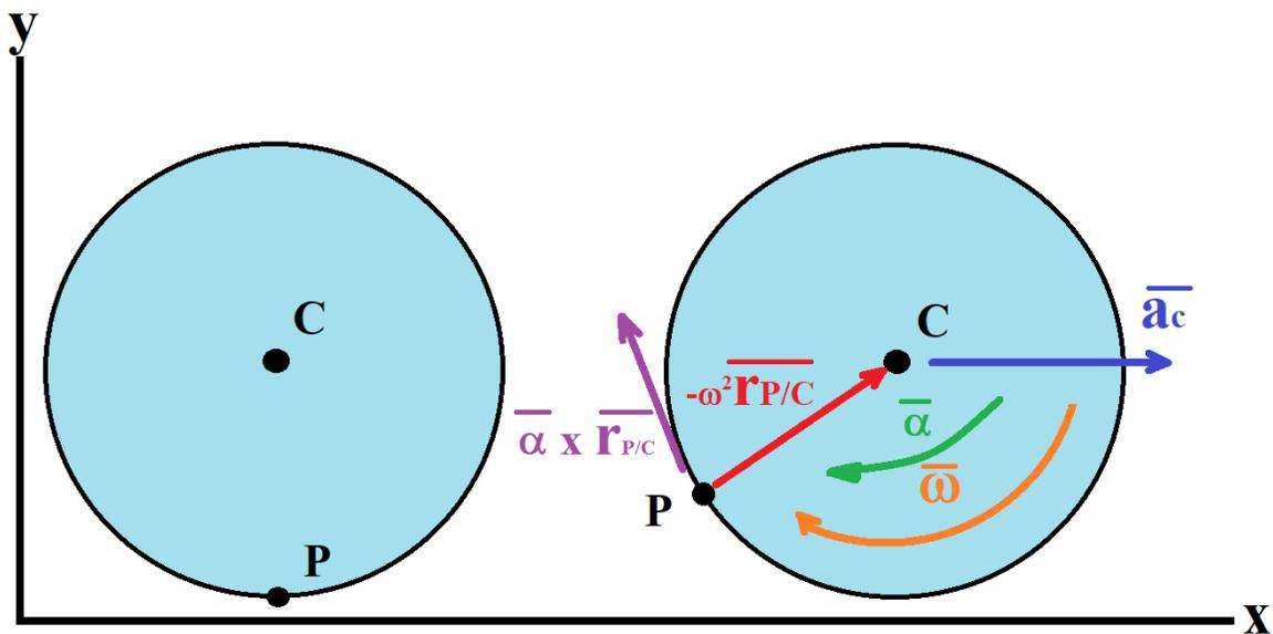
Figura 5. Aceleración de un cuerpo rígido que experimenta movimiento plano general: El vector  $\bar{\mathbf{a}}_C$  es la aceleración lineal que experimenta el centro de rotación del cuerpo C, P es cualquier punto de análisis en el cuerpo rígido, el vector  $\bar{\mathbf{r}}_{P/C}$  es el vector que va desde el centro de rotación al punto de análisis P,  $\omega$  es la velocidad angular del cuerpo con respecto de C y  $\alpha$  es la aceleración angular del cuerpo con respecto de C.
