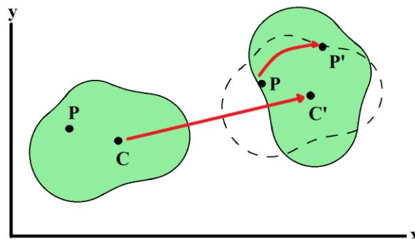
Figura 2. Movimiento plano general compuesto por una traslación de  $C$  a  $C'$  y una rotación de  $P$  a  $P'$  en torno a  $C$
