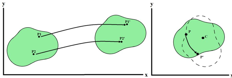
Figura 1. Traslación de los puntos  $P1$  y  $P2$  a  $P1'$  y  $P2'$  (izquierda) y Rotación del punto  $P$  a  $P'$  en torno a un eje que pasa por el punto  $C$  y perpendicular al plano de movimiento (derecha)
